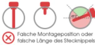
Falsche Montageposition oder falsche Länge des Stecknippels
