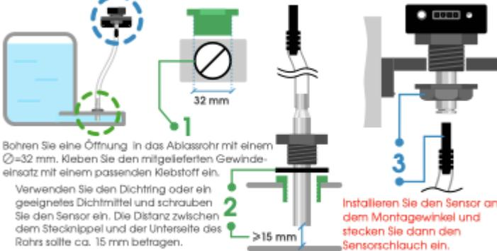
Bohren Sie eine Öffnung in das Ablassrohr mit einem  $\varnothing=32$  mm. Kleben Sie den mitgelieferten Gewinde-einsatz mit einem passenden Klebstoff ein.
